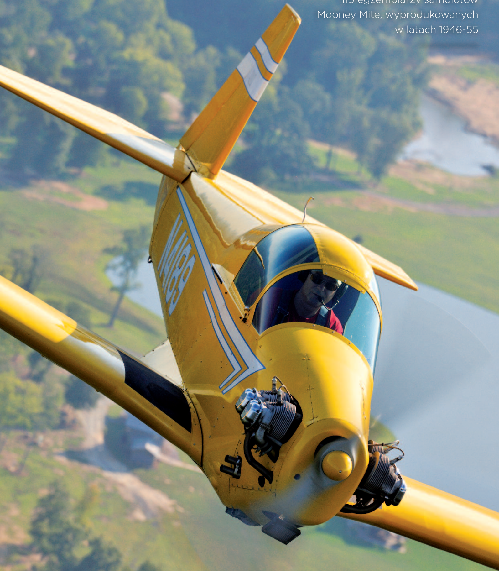
Od modelu M-18 Mite cechą wyróżniającą wszystkie konstrukcje Mooney jest „zadziorne” usterzenie pionowe o ujemnym skosie
