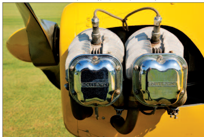
Silnik Continental A-65 – wersja licencyjna produkcji Rolls Royce
