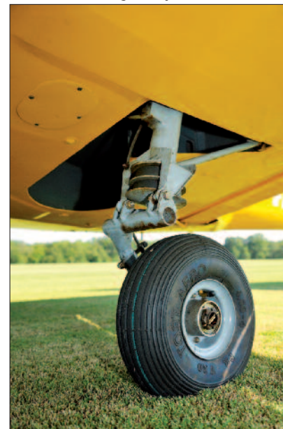
Podwozie wahaczowe amortyzowane klockami gumowymi
