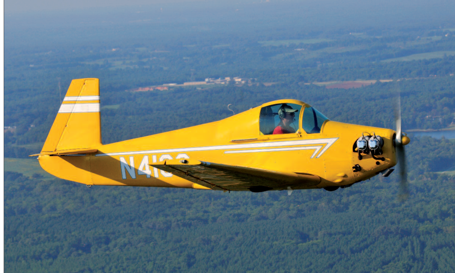
Od modelu M-18 Mite cechą wyróżniającą wszystkie konstrukcje Mooney jest „zadziorne” usterzenie pionowe o ujemnym skosie
