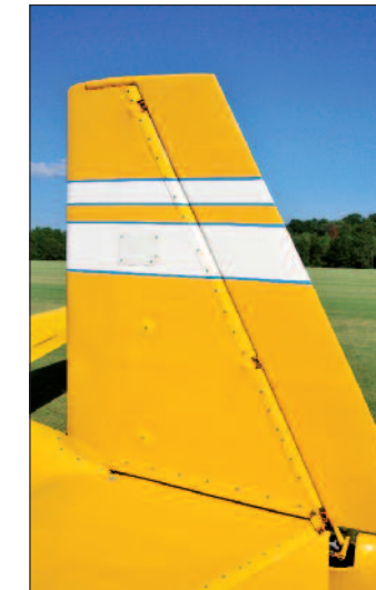
Skośna do przodu oś zawiasów steru kierunku – jak podpis Konstruktor
